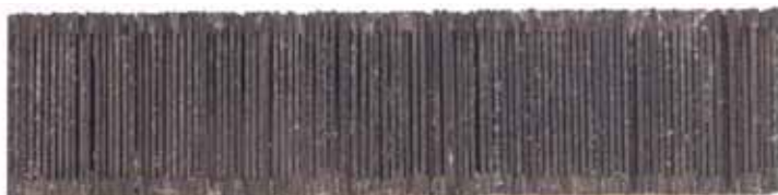
Fotografija AMR-ja, ki je med vsemi do sedaj testiranimi rešitvami ploščnih regenera-torjev ustvaril v svetovnem največji temperaturni razpon (na enoto apliciranega magnetnega polja).
