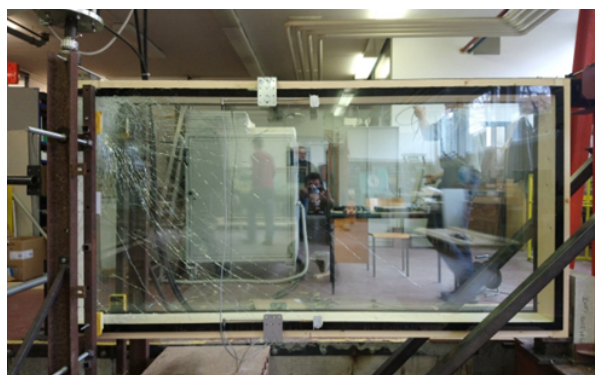
Slika 2: Prikaz mehanizma loma lesenega DSF stenskega elementa med eksperimentalnim testiranjem.
