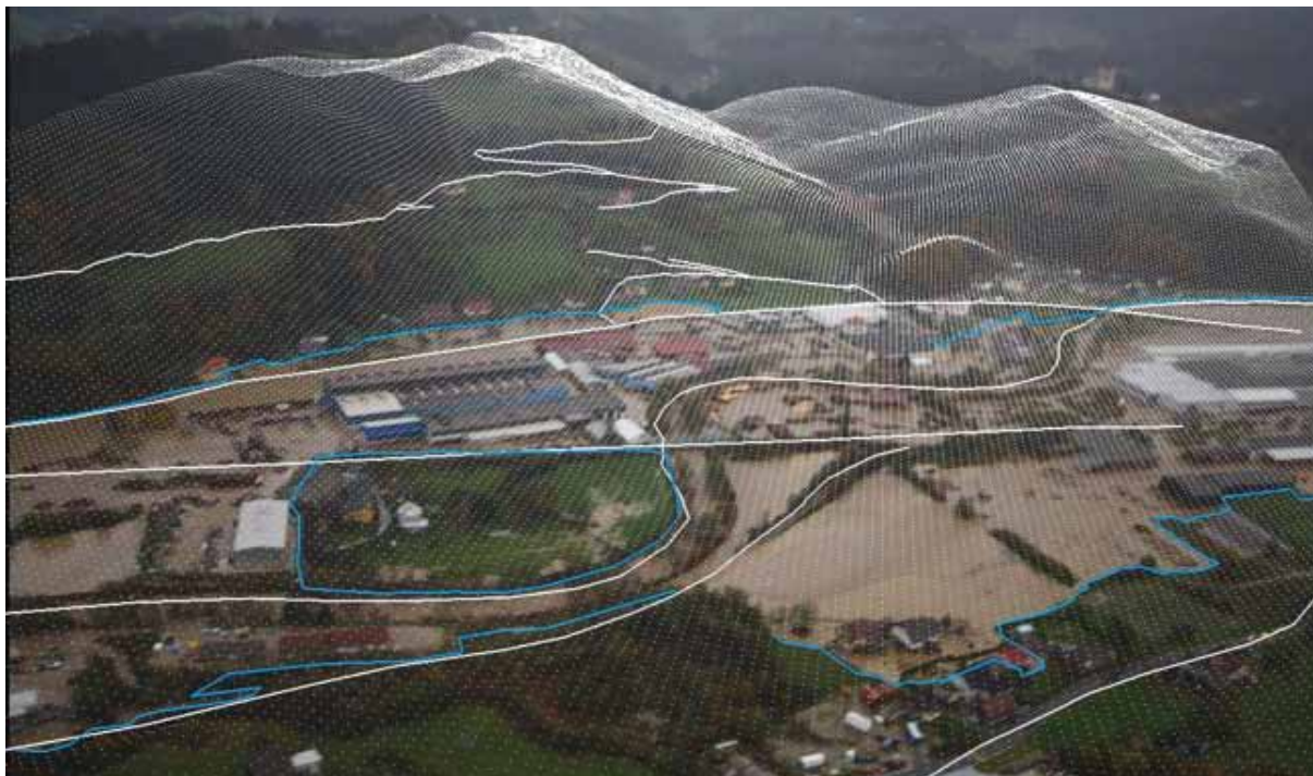
Prileganje DMR (bele pike), vektorjev cest (bele linije) in zajetih vektorjev poplavljenih območij (modre linije) na vsebino fotografije v postopku izvedenja poplavljenih območij. (Avtorja fotografije Dravograda: Dominik in Damjan Cehner, Avifun d.o.o.)
